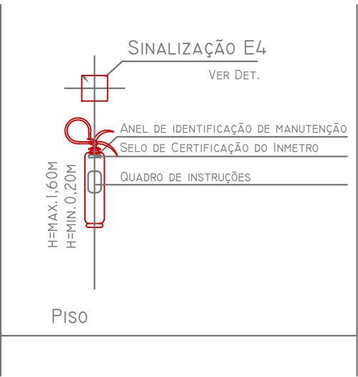
DETALHE FIXAÇÃO EXTINTOR SEM ESCALA
